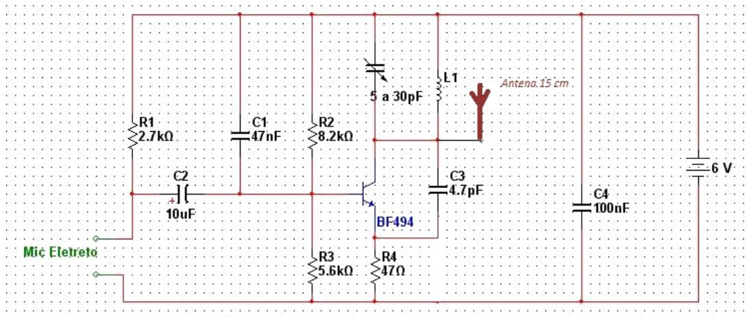
Você pode usar um microfone de eletreto comum, de 2 terminais na entrada, utilizar este circuito para espionagem, escondido dentro de um vaso por exemplo. Pode também, no lugar do microfone, inserir sinais de audio de um CD-Player, mp3-Player, etc; utilizando como pequena rádio.
