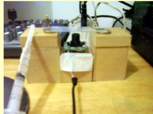
microscópio diy adaptado com caixas de madeira e 4 coroas norueguesas
